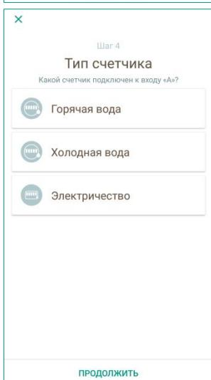
6. Выберите, счетчик какого типа подключен к клемме А на плате датчика (см. схему подключения на стр. 55).
