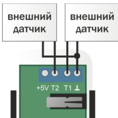
2. Подключите провода внешних сенсоров к клеммам на плате датчика в соответствии со схемой подключения.
